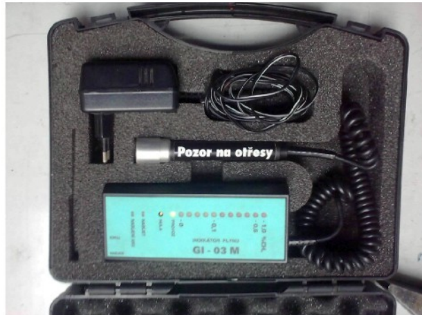
Obr.20 – zařízení na detekci methanu
