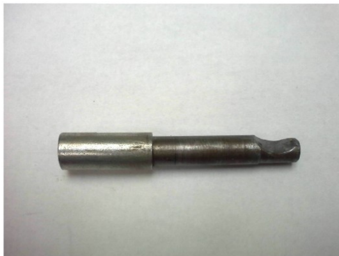
Obr 5. Technologický přípravek na demontáž vefuku
