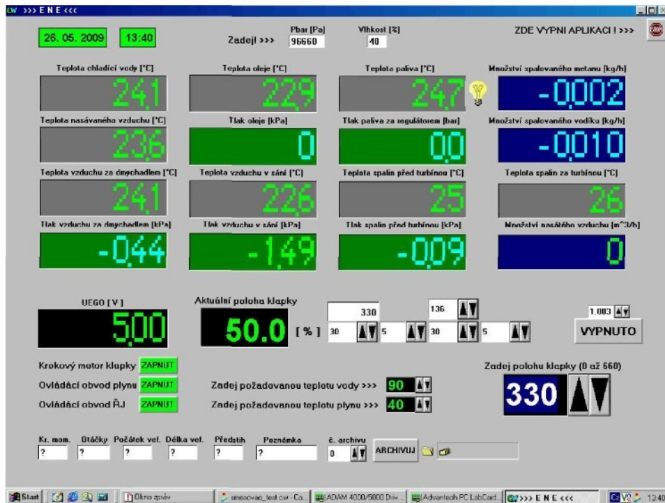
Obr.21 – ControlWeb 2000 – ovládání škrťící klapky
