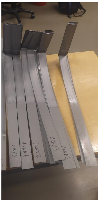
Obr. 32 Pásy plechu po tažení přes brzdící lištu a tažnou hranu
