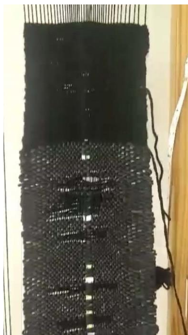
Obrázek 22. LED pásek vetkaný do tapiserie
