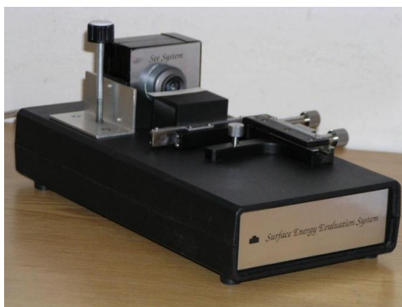
Obrázek 14: Zařízení pro měření kontaktního úhlu [42]
