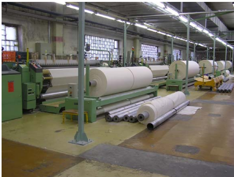
Obr. č. 6 Tkací stavy Dornier s instalovanými velkonábaly
