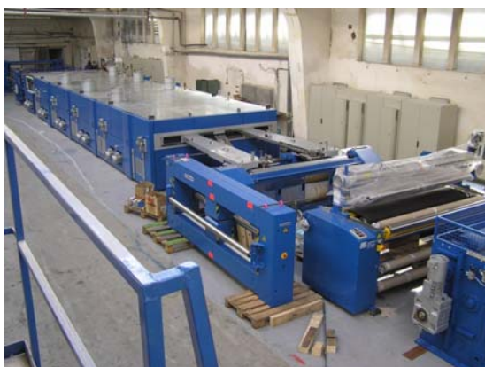
Obr. č. 8 Stavba rámu Bruckner II
