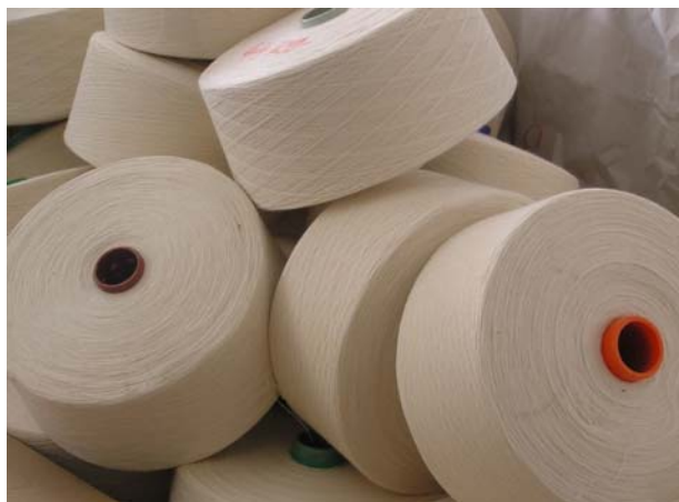
Obr. č. 4 Příklad konečného výrobku, příze na dutince
