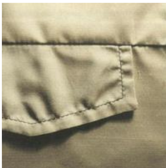
Obr. 19. Vada: Vrásnění švu [14]
