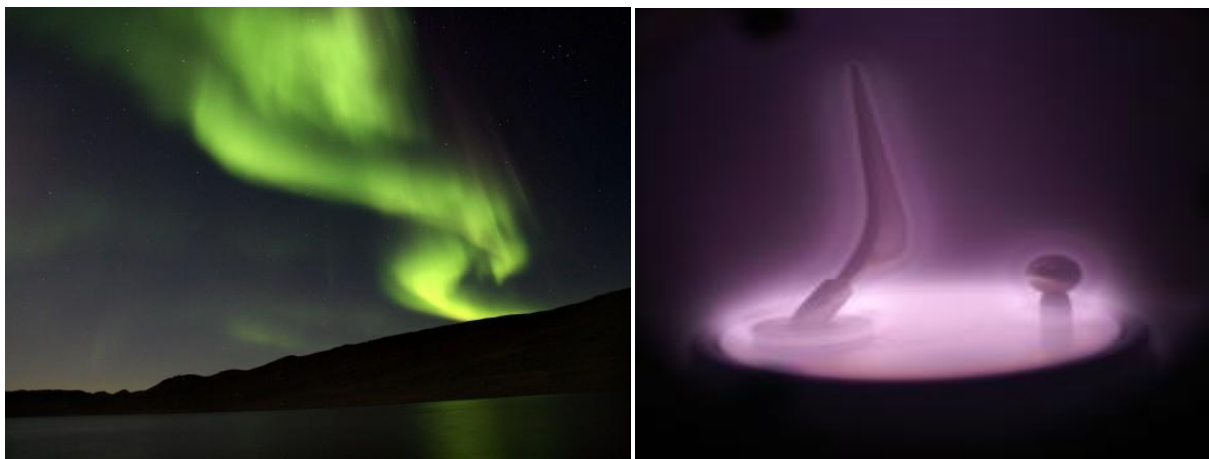
Obr. 1. Příklady plazmatu a) polární záře [1], b) argonová plazma v reaktoru RF PACVD
