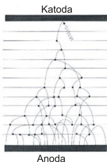
Obr. 5. Elektronová lavina v mezi-elektrodové oblasti
