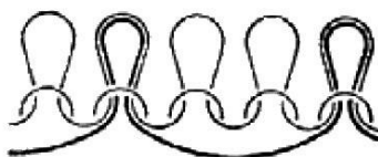
Obr. 6 Schéma zátažné jednolící pleteniny s doplňkovými nitěmi: krytý výplněk z rubové strany [14]
