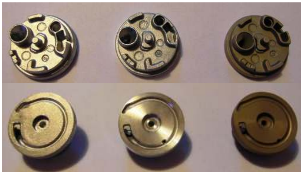
Obr. 1 – Hliníkové odlitky před obrobením, po obrobení a povlakované
