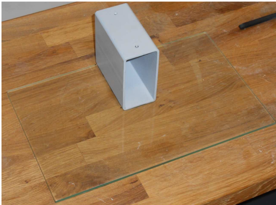
Obr. 48: Základní deska (sklo) s nalepeným adaptérem pro držák
