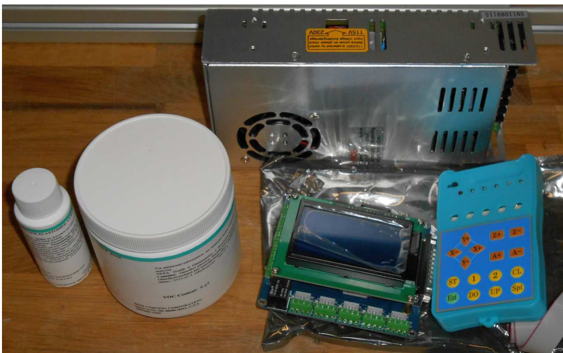
Obr. 50: Vlevo přípravek Sylgard 184, vpravo dole řídicí deska s ručním ovládáním, nahore průmyslový stejnosměrný zdroj 24V 350W
