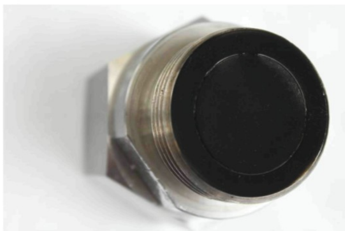
Obr. 22 Sklo po 10 minutovém provozu motoru při plném zatížení
