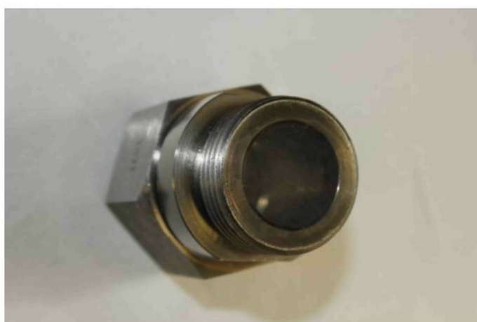
Obr. 21 Sklo po 10 minutovém provozu motoru při nízkém zatížení
