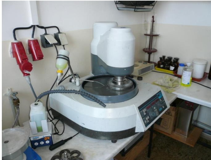
Obr. 25 Rotační bruska na vzorky Phoenix 4000 – laboratoř TUL
