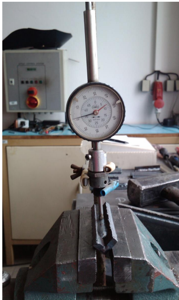
Obr. 28 – Měření velikosti boulování – laboratoř TUL
