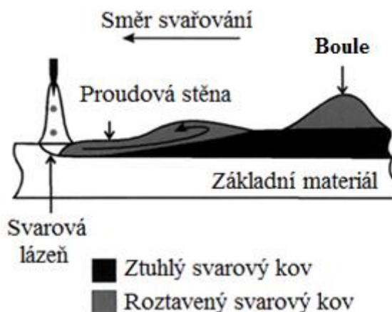
Obr. 18 Podélný řez svaru [13]
