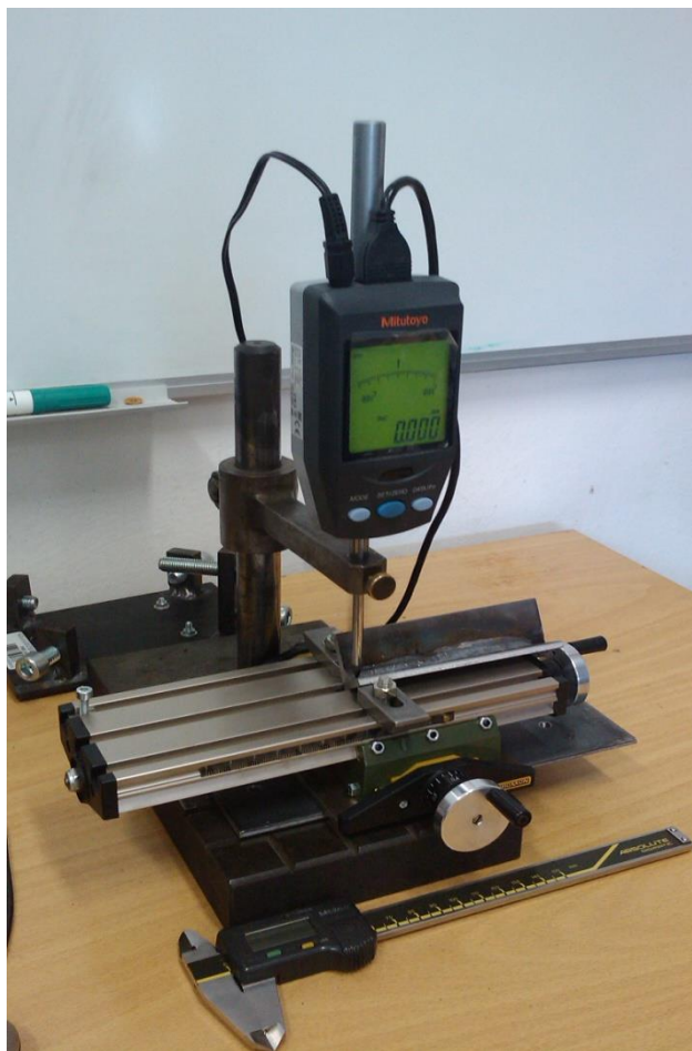
Obr. 30 Přípravek na měření zápalů svarů – laboratoř TUL
