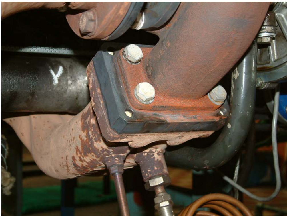
obr. 4 Úprava výfukového potrubí na vstupu do turbíny.
