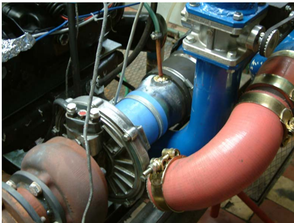
obr. 3 Úprava sacího potrubí.
