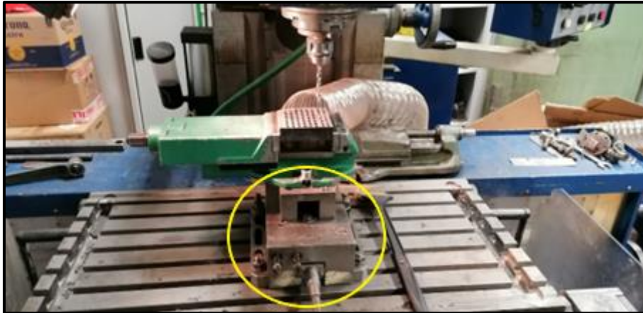
Obrázek 14 – dynamometr je vidět ve žlutém kroužku; k dynamometru je pomocí šroubů připevněn strojní svěrák, ve kterém je upnut obrobek; dynamometr je ke stolu přichycen pomocí šroubů a T-matic
