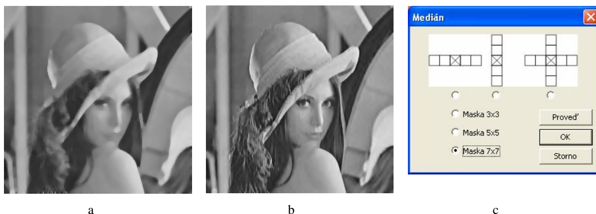
Obr. 3.28 Medián, vstupní obraz obr. 3.8 - (a) filtrace maskou 7x7, (b) filtrace pomocí vertikální masky, (c) dialogové okno Medián
