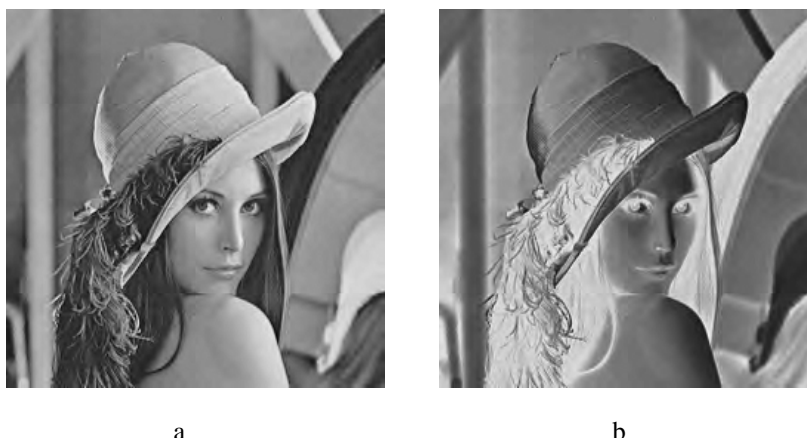
Obr. 3.17 Negativ, (a) vstupní obraz, (b) negativ obrazu
