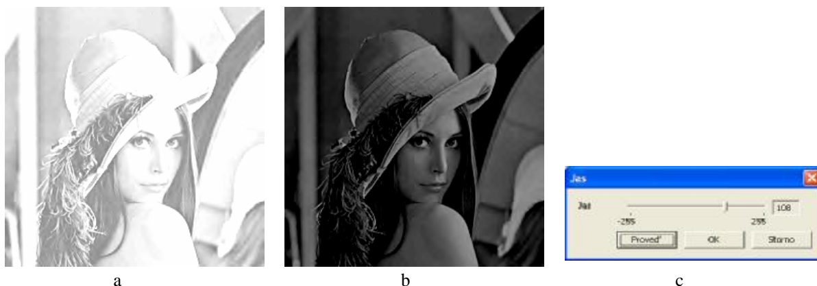
Obr. 3.19 Změna jasu obrazu, vstupní obraz obr. 3.8 - (a) jas = -74, (b) jas = 108, (c) dialogové okno Jas
