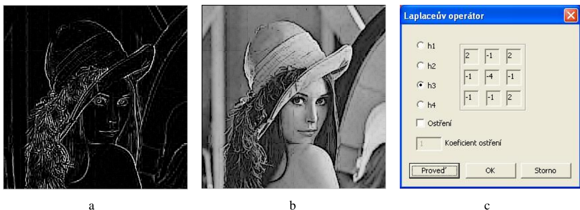
Obr. 3.30 Laplaceův operátor, vstupní obraz obr. 3.8 - (a) detekce hran maskou h_3 , (b) ostření s koeficientem 0.8, (c) dialogové okno Laplaceův operátor
