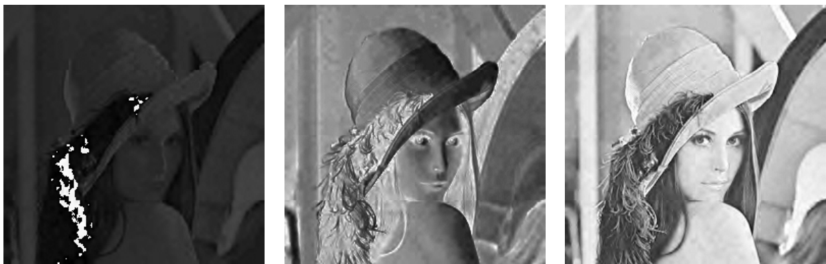
Obr. 3.12 Převod RGB na jednotlivé složky (a) H , (b) S , (c) V z modelu HSV
