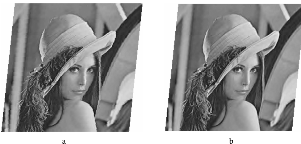
Obr. 3.23 Zkosení, vstupní obraz obr. 3.8 - (a) interpolace metodou nejmenšího souseda, (b) bikubická interpolace
