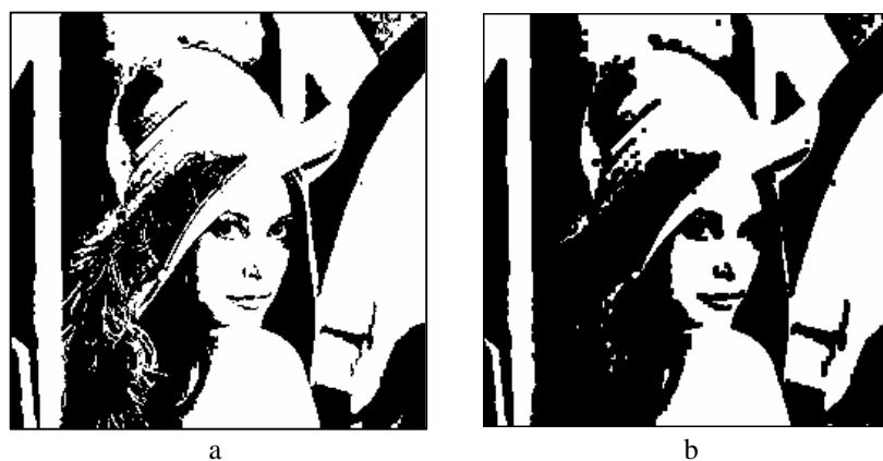
Obr. 3.34 Eroze - (a) vstupní obraz, (b) eroze
