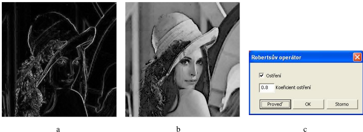
Obr. 3.29 Robertsův operátor, vstupní obraz obr. 3.8 - (a) detekce hran, (b) ostření s koeficientem 0.8, (c) dialogové okno Robertsův operátor
