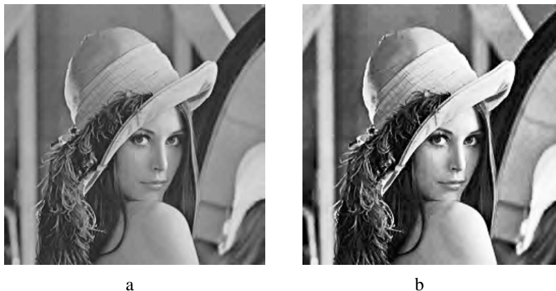
Obr. 3.21 Ekvalizace histogramu, (a) vstupní obraz, (b) výstupní vpravo
