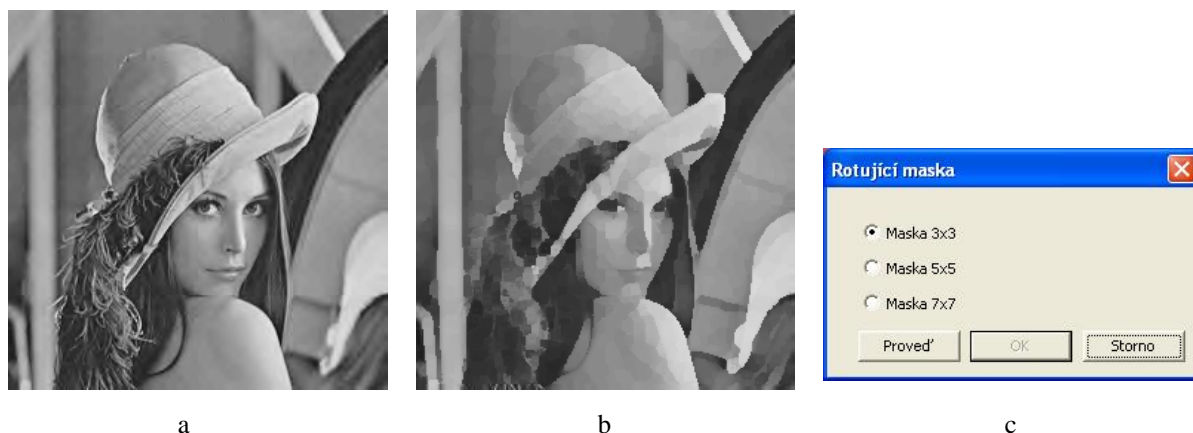
Obr. 3.27 Rotující maska - (a) vstupní obraz, (b) filtrace maskou 3x3, (c) dialogové okno Rotující maska
