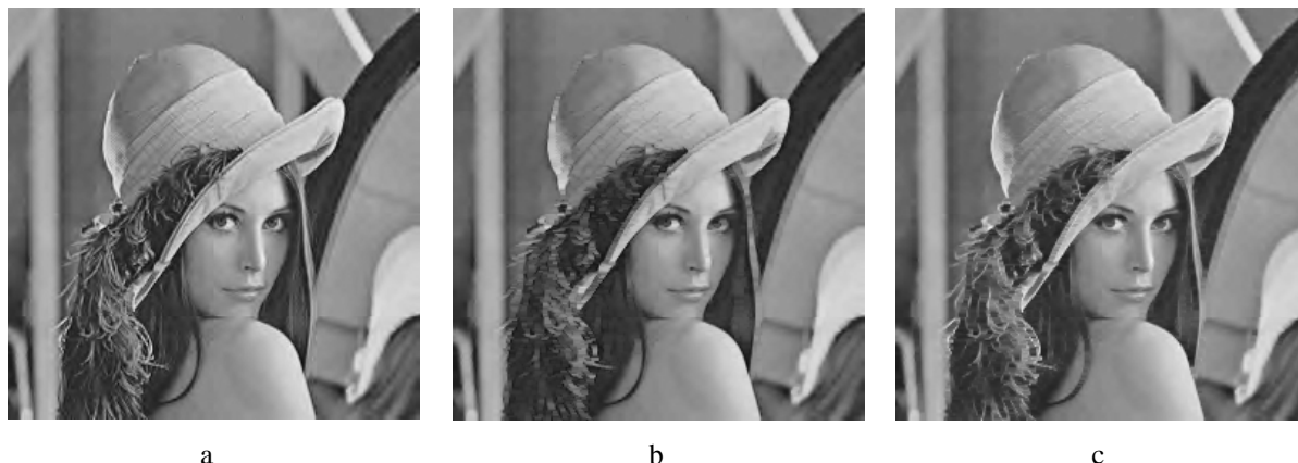
Obr. 3.37 Šedotónová matematická morfologie - (a) vstupní obraz, (b) otevření, (c) uzavření
