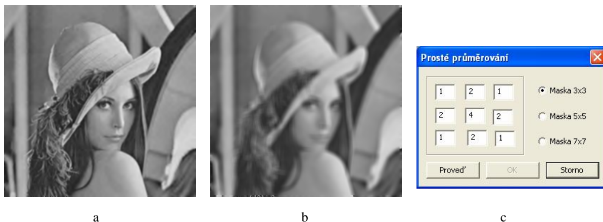
Obr. 3.26 Prostý průměr, vstupní obraz obr. 3.8 - (a) filtrace s maskou 3x3 s největší vahou uprostřed, (b) maska 7x7, (c) dialogové okno Prostý průměr
