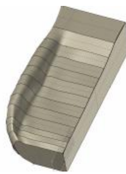
Obr. 213 Zobrazení modelu po funkci Trim (po ořezu)
