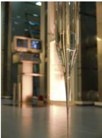
Obr. 1.3.1 Preforma vyrobená MCVD metodou [7]
