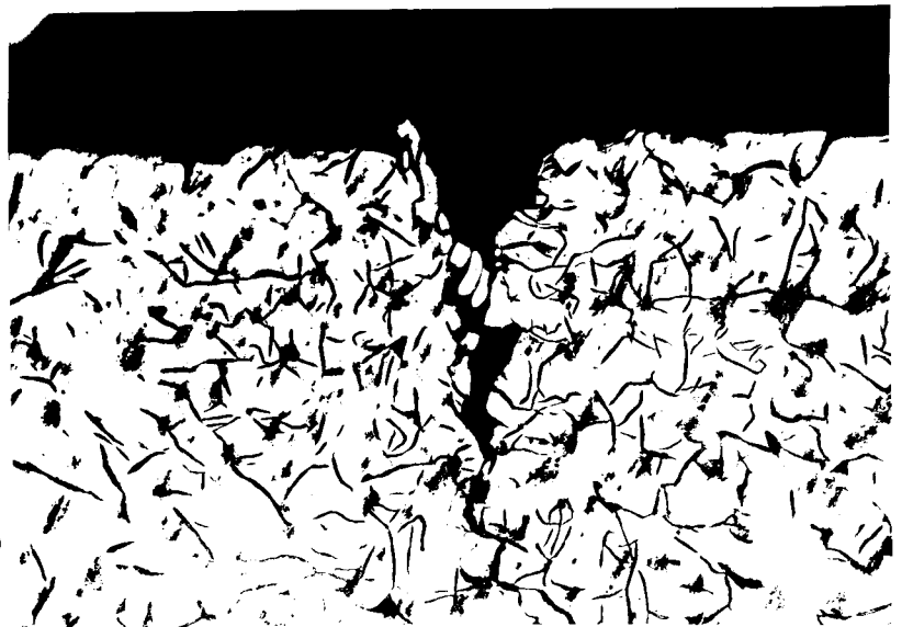
Obr.3. Trhlina - makro zvětšeno 50x
