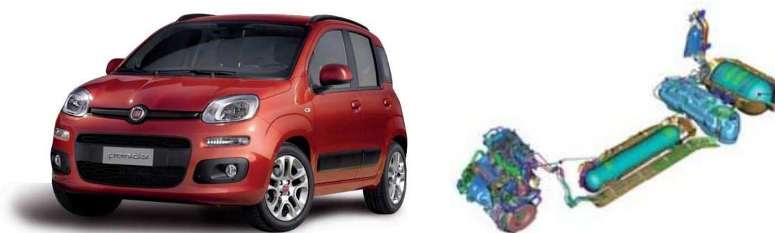
Obr. 21 Fiat Panda CNG, palivový systém Fiatu Panda CNG [21]
