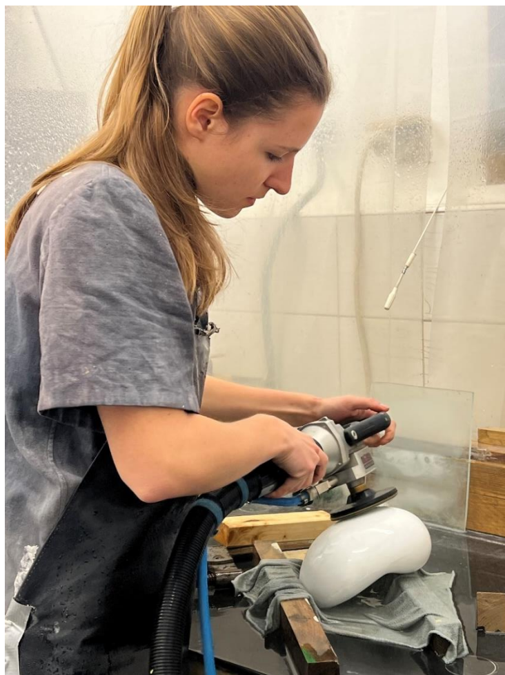
Obrázek 36- Broušení s pneumatickou ruční bruskou (flexou)
