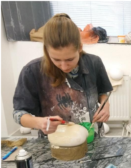
Obrázek 25-26- Natírání modelu kondenzačním silikonem
