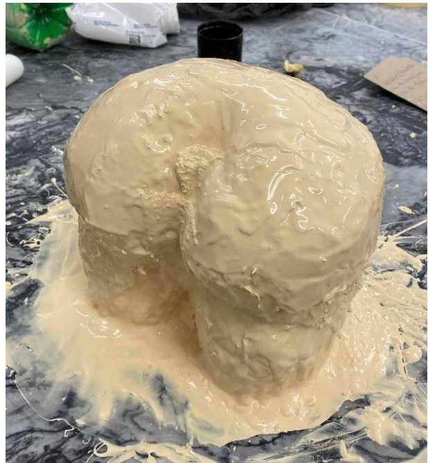
Obrázek 25-26- Natírání modelu kondenzačním silikonem
