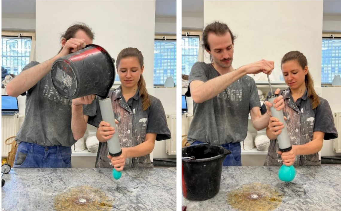
Obrázek 17-18- Postup naplňování balónku sádrou
