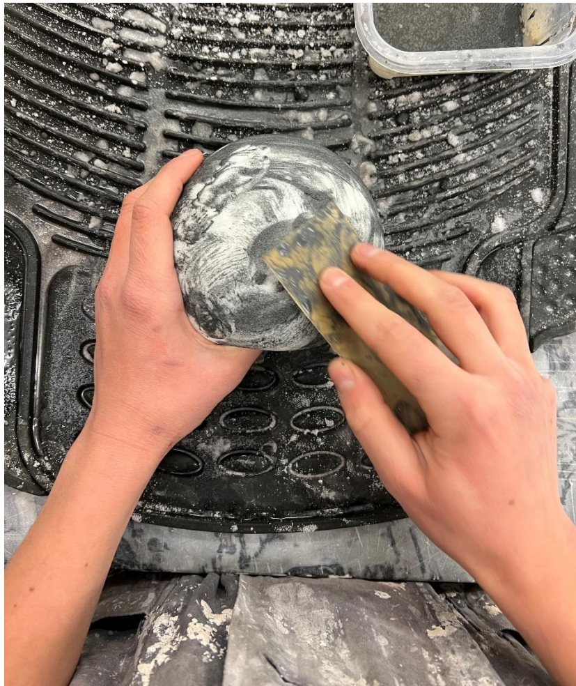
Obrázek 37- Jemnění pomocí plíšku a smirku
