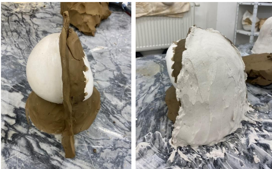
Obrázek 21-22- Formování vícedílné formy
