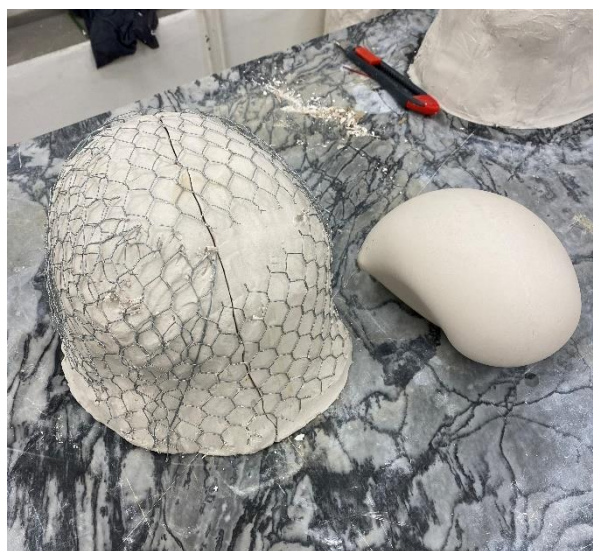
Obrázek 24- Forma po vyndání modelu, obmotaná pletivem, připravená na zalití sádrou
