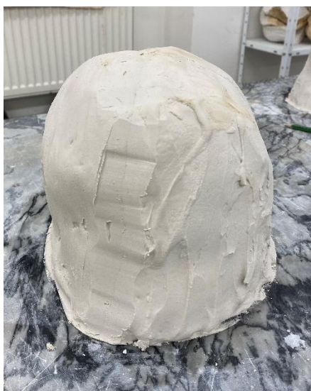
Obrázek 23- Dvoudílná forma těsně po zaformování
