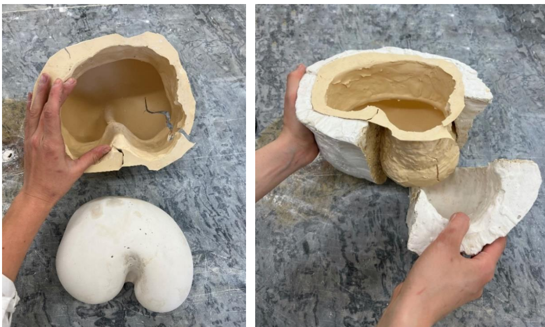
Obrázek 27-28- Silikonová a opěrná sádrová forma
