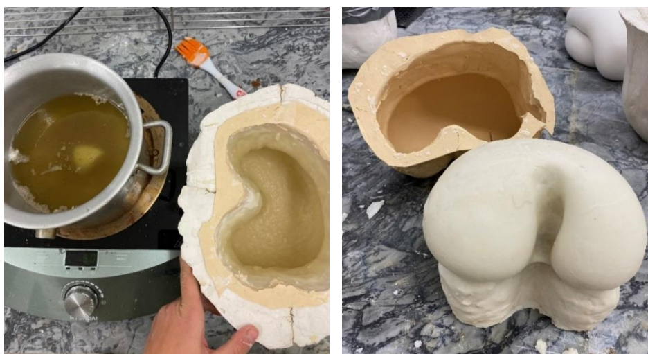
Obrázek 29-30- Vylévání voskem a voskový odlitek
