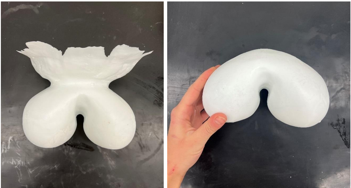
Obrázek 34-35- Skleněný objekt před a po uříznutí násypnice
