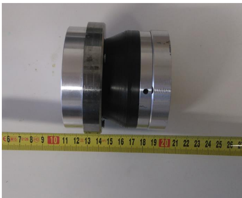
Obrázek 37: Magnetická zarážka v okamžiku působení přitažlivé magnetické síly
