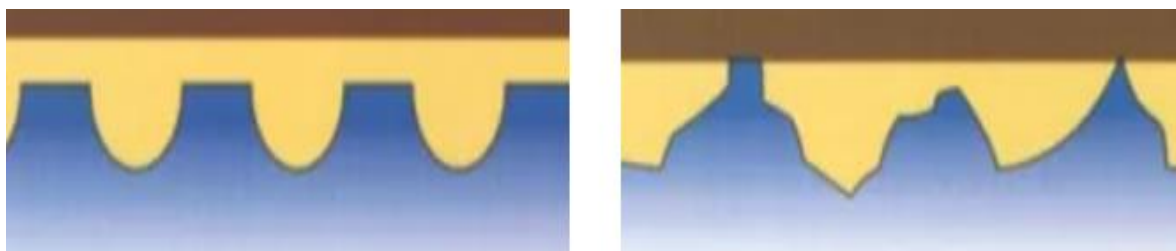
Obr. 24 Ukázka vhodného (vlevo) a nevhodného (vpravo) plechu pro tváření [26]
