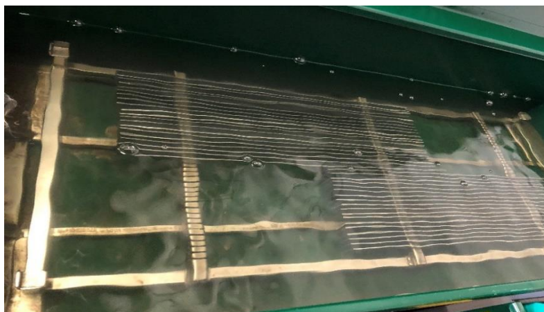
Obr. 25 Odmaštění zkušebních vzorků v lázni
