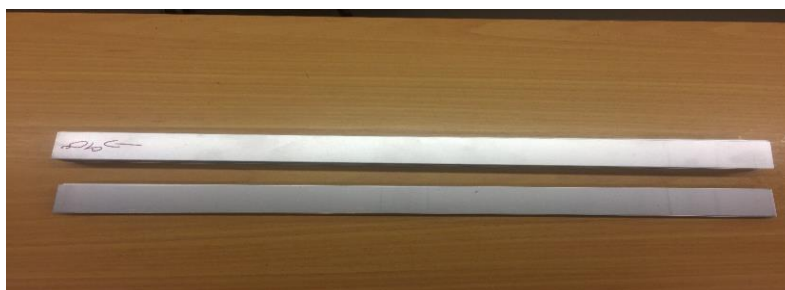
Obr. 26 Nastříhané a odmaštěné zkušební vzorky
