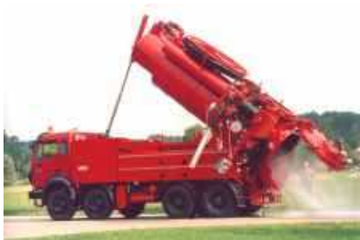
Obr. 19 Vykládka odpadu sklopením nádrže
