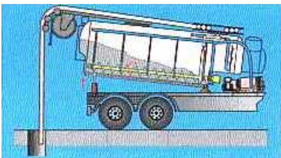
Obr. 16 Odvodnění zbývajících nerostných materiálů uvnitř kalové nádrže
