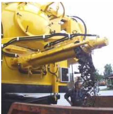
Obr. 18 Vykládka odpadu pomocí šroubového dopravníku
