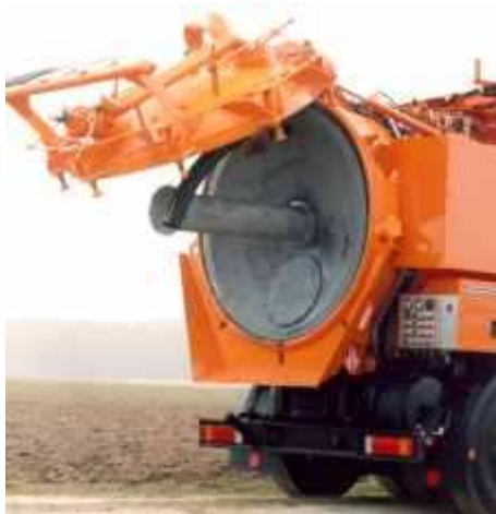
Obr. 17 Vykládka odpadu pomocí hydraulického pístu
