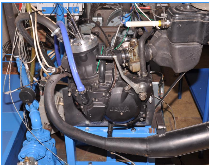
Obr. 43: Detail motoru na brzdovém stanovišti
