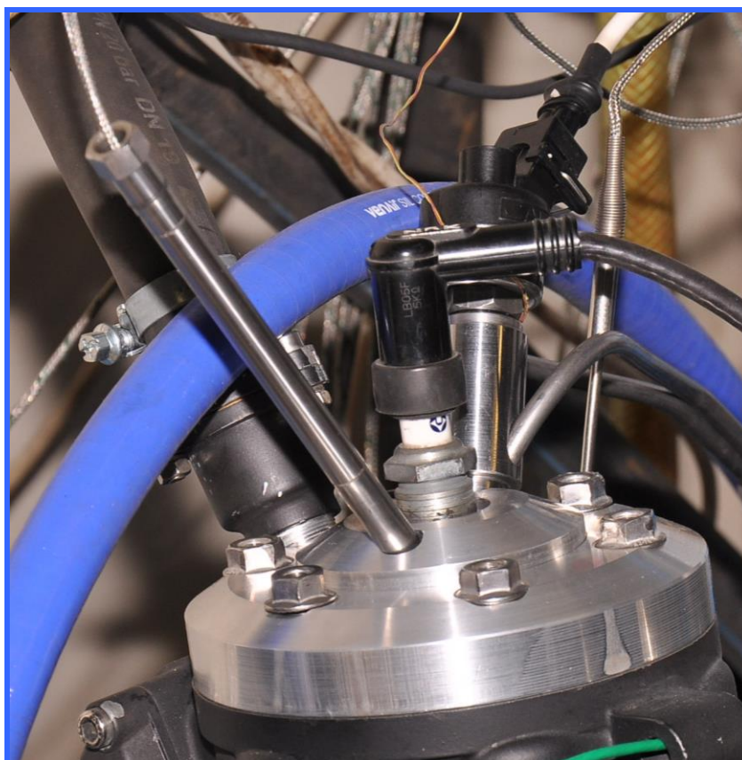
Obr. 44: Detail zkušební hlavy válce s odběrným ventilem
