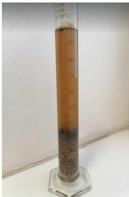
Obrázek 2: Hustotní separace pomocí ZnCl_2
