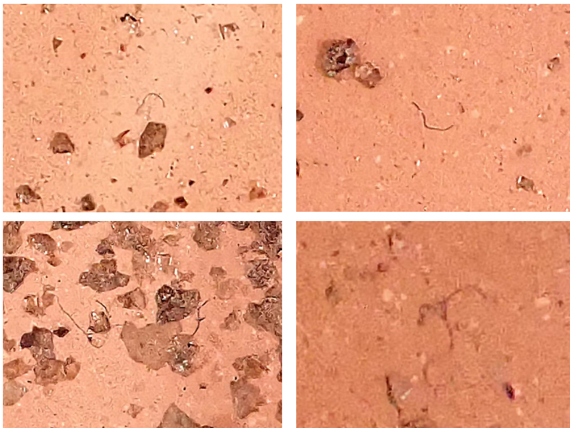
Obrázek 18: Bližší záběr nalezených vlákněných mikroplastů u vzorků 1.2, 2.2, 5.1, 5.2
