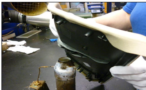
Obr č. 18 Lemování zadní hrany pomocí zařízení Leister
