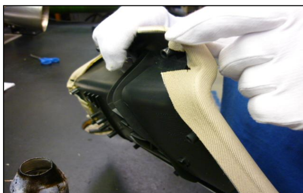
Obr č. 17 Ruční lemování okrajů pomocí zařízení Leister
