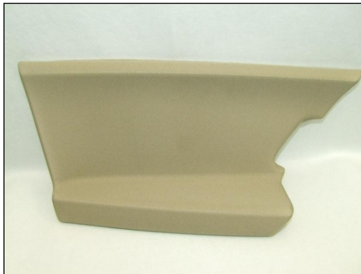
Obr. č. 21 Vzorek C – nalisovaný insert bez vrásky, s viditelným průsakem a pomerančovým efektem
