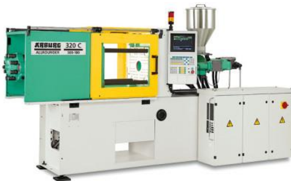
Obr. 3.4 Hydraulický vstřikovací stroj ARBURG Allrounder 320 C Golden Edition [81]
