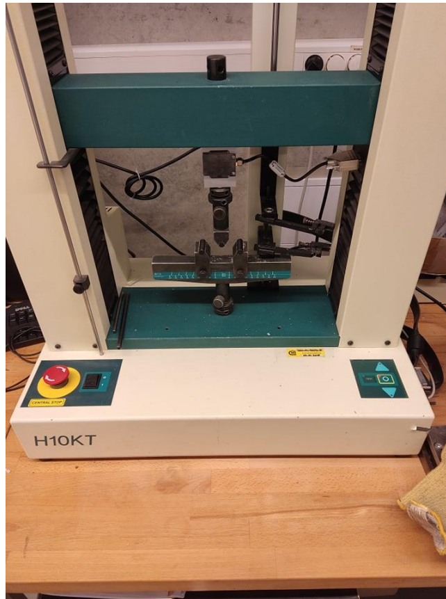
Obr. 3.26 Zařízení pro zkoušku ohybem Hounsfield H10KT
