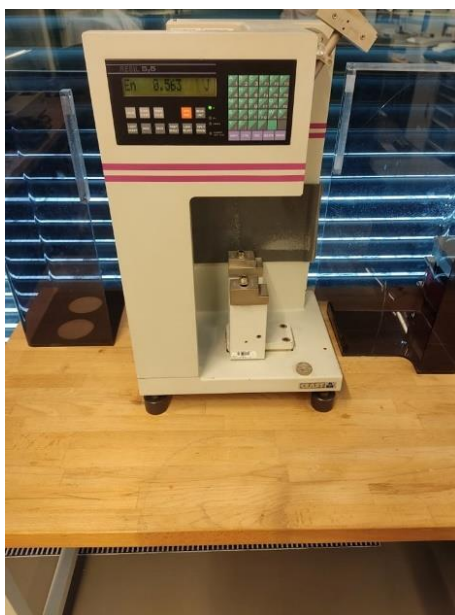
Obr. 3.27 Zařízení pro zkoušku rázové houževnatosti metodou Charpy Ceast Resil 5.5
