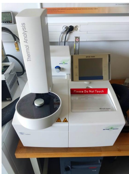
Obr. 3.12 Diferenční snímací kalorimetr Mettler Toledo DSC 1
