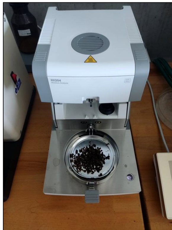
Obr. 3.7 Zařízení pro měření zbytkové vlhkosti HX 204 Mettler Toledo
