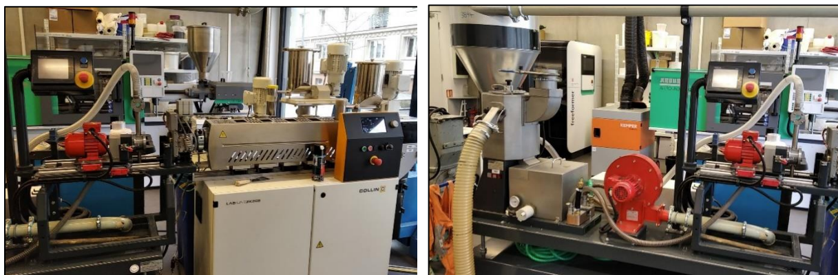
Obr. 3.3 Vytlačovací stroj (extrudér) Collin ZK 25 E (vlevo) a granulátor Econ Ewa 10 (vpravo)
