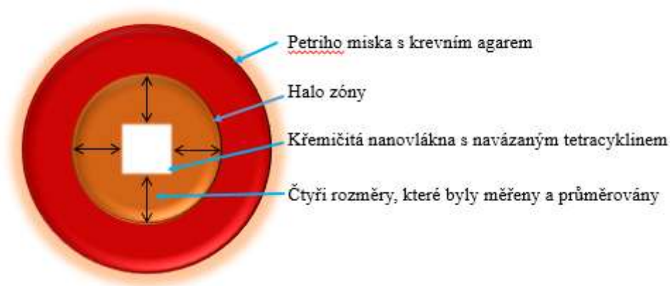
Obr. 3.5 Způsob odečítání rozměrů halo zóny při testování vzorků. Oboustranné šipky znázorňují měřené rozměry.
