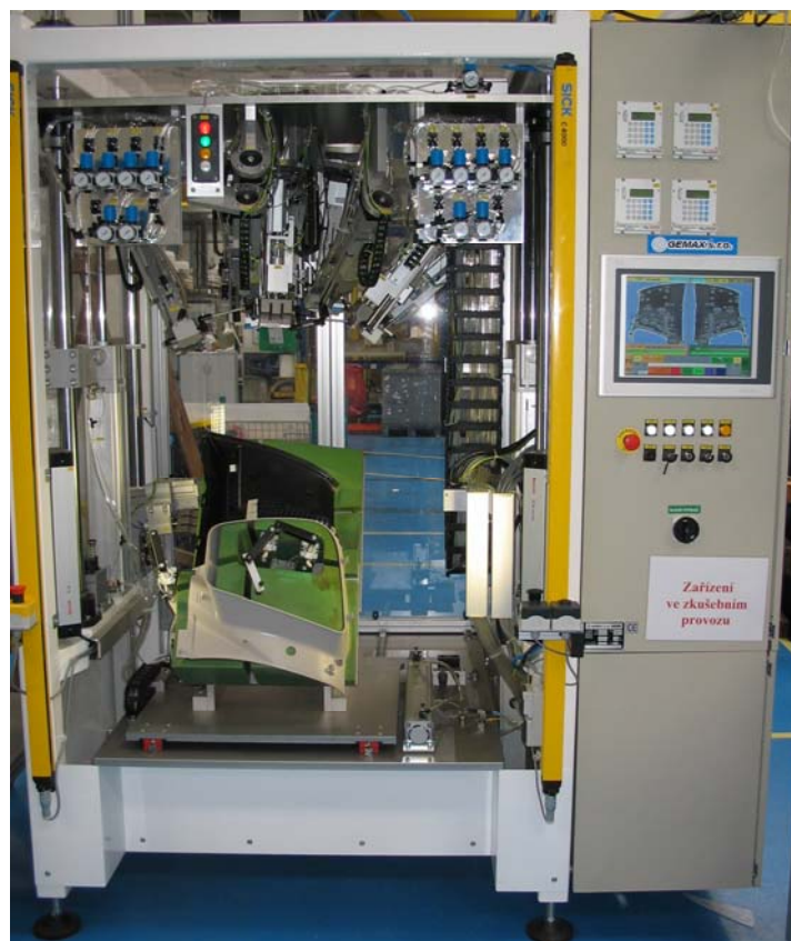
Obr. 3.6: Ultrazvukové svařovací zařízení se založenými komponenty CD sloupku [34]
