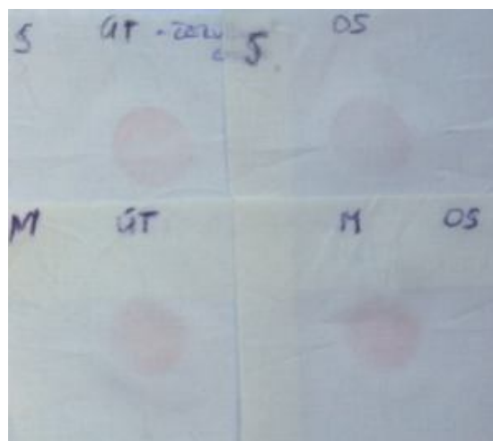
Obr. č. 46 – Ukázka zapuštění barvy u textilie „C“ po zkoušce otěru
