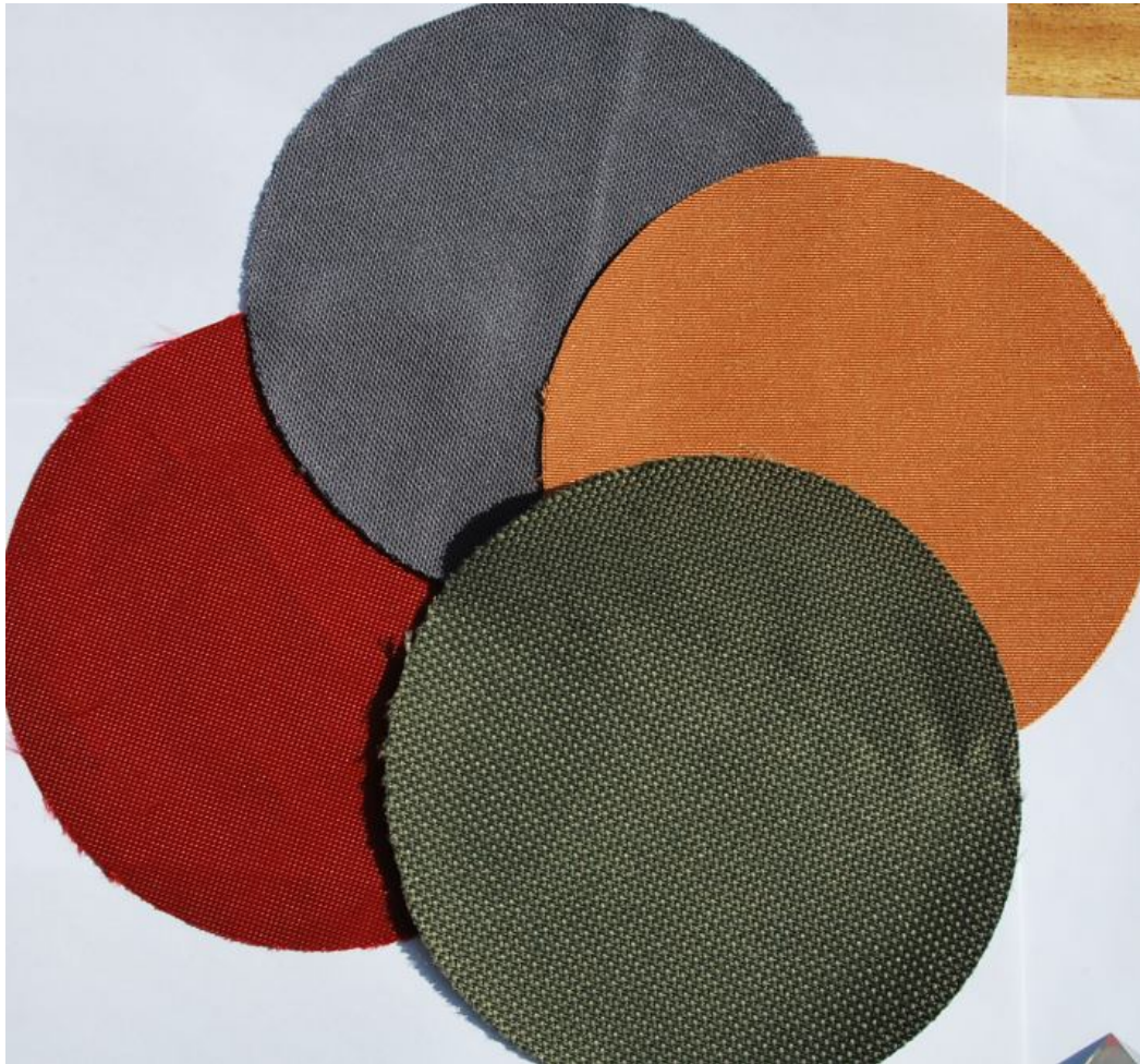
Obr. č. 47 – Vzorky hodnocených textilií po zkoušce žmolkovitosti
