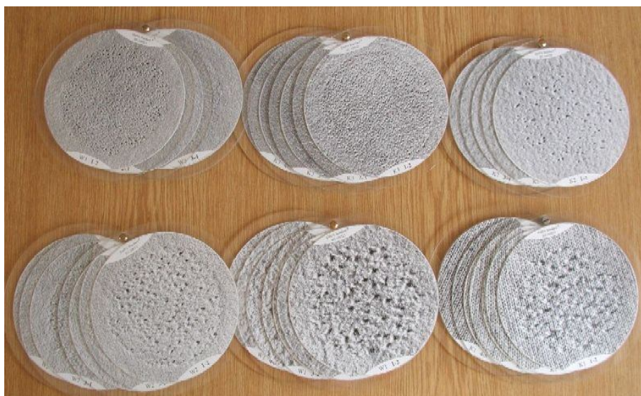
Obr. č. 22 – Ukázka fotografických etalonů pro hodnocení žmolkovitosti[23]
