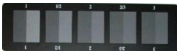
Obr. č. 28 – Ukázka šedé stupnice pro hodnocení změny odstínu[3]
