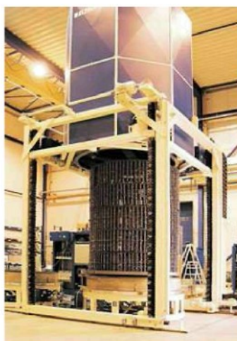
Obr. 8: Plasmová pec pro excentrické hřídele firmy Eltro, USA
