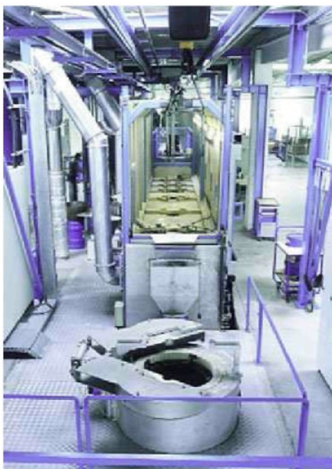
Obr. 3: Zařízení pro karbonitridaci v solné lázni firmy Houghton Durferrit, USA
