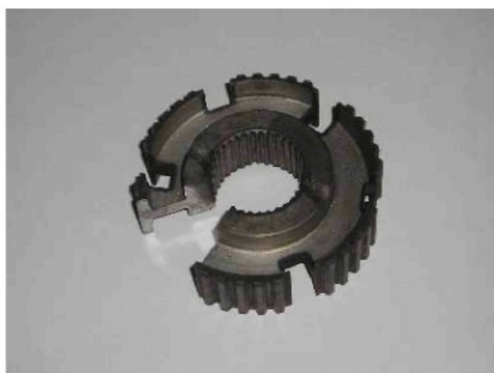
Obr. 14: Jádro spojky po odebání vzorků pro metalografickou analýzu
