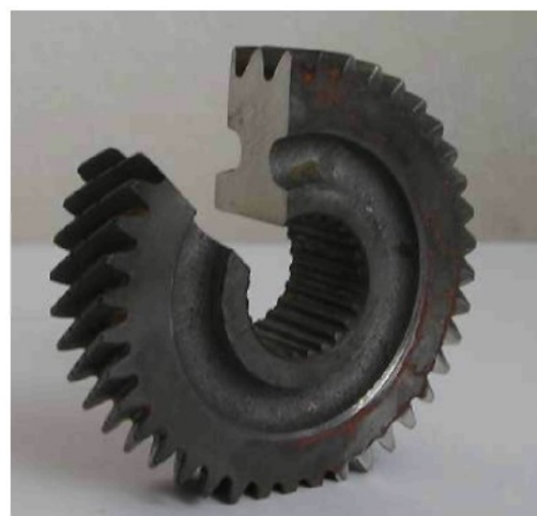
Obr. 17: Nitrocementované ozubené kolo po debrání vzorků
