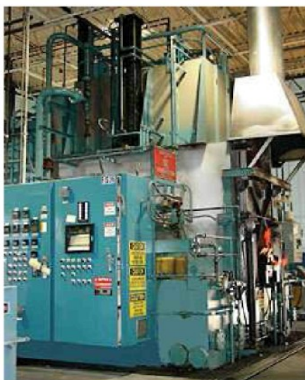
Obr. 5: Karbonitridační pec firmy Service Heat Treating, USA
