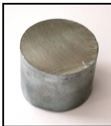
Obr. 11 Vzorek ve tvaru válce na zkoušku spektrometrem
