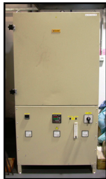
Obr. 9 Elektrická odporová komorová pec značky Clasic
