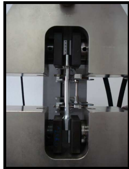
Obr. 19 Upnutí vzorku mezi čelisti trhačího stroje
