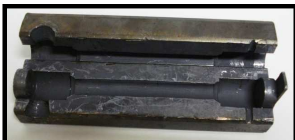
Obr. 12 Kovová forma k odlévání vzorků pro statickou zkoušku tahem
