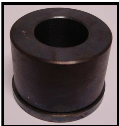
Obr. 10 Kovová forma pro odlévání vzorků na zkoušku spektrometrem
