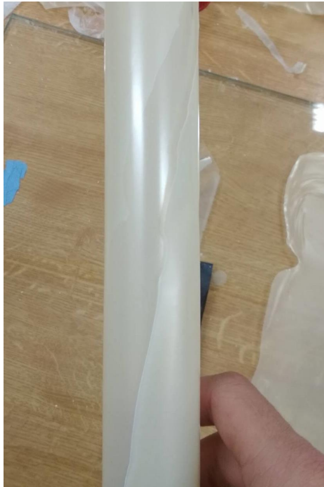
Obrázek 24 Ukázka možnosti ohýbání membrány z houževnatého polystyrenu
