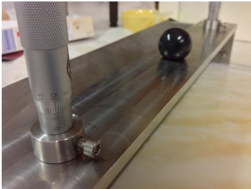
Obrázek 20 Detailní foto mikrometrů pro nastavení mezery
