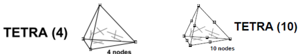
Obrázek 49 – zvolený prvek pro tvorbu sítě MKP modelu [17]
