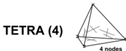
Obrázek 39 – zvolený prvek pro tvorbu sítě MKP sub-modelu [17]
