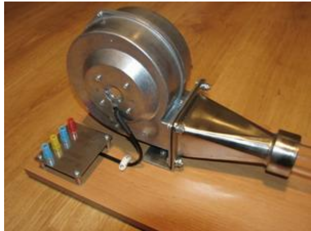
Obr. 22 : Destička pro napájecí konektory + zhotovený přípravek(ventilátor,přechodka)
