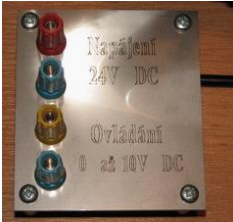
Obr. 22 : Destička pro napájecí konektory + zhotovený přípravek(ventilátor,přechodka)
