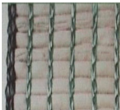
Obr. 2 Pletenina typu Repotex S, ze savých NT v kombinaci řetízku s kladením pod jehlami. Pletenina slouží jako podklad pro ozelenění. [3]
