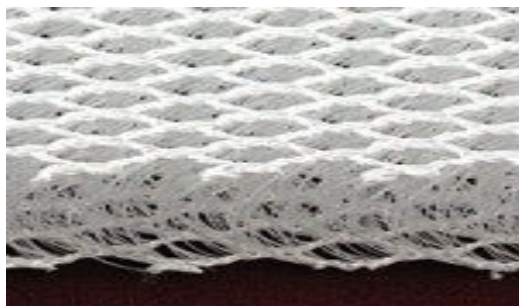
Obr. 3 3D pletenina s otevřenou strukturou na obou stěnách pleteniny, spojená monofilovými vlákny. [7]
