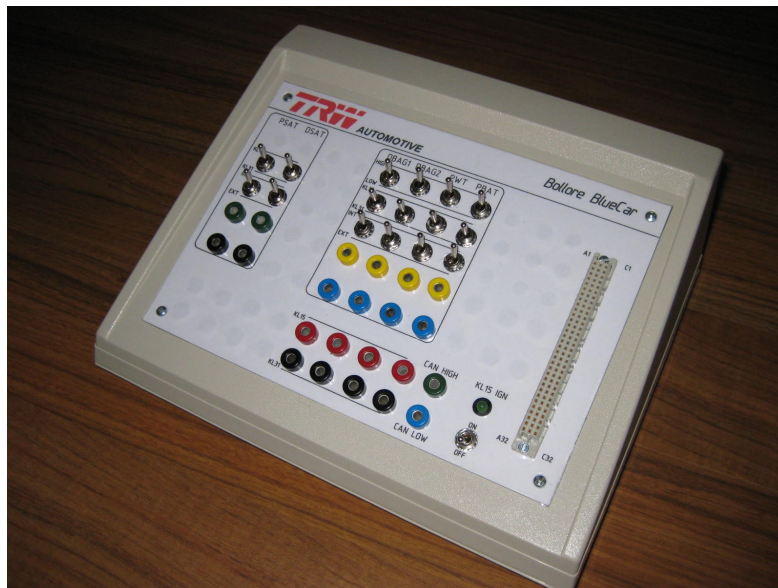
Obr. 3 Jednotka simulující ECU
