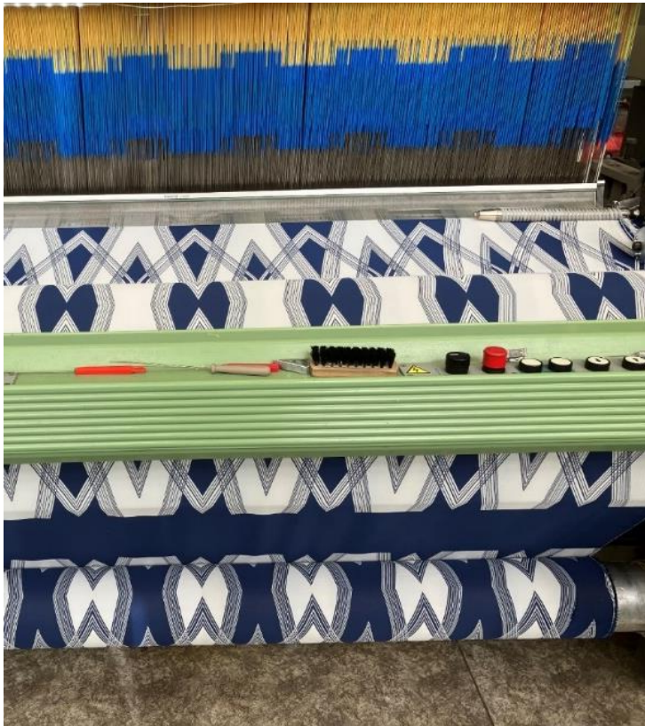
Obrázek 23 Tkaní vzoru na jehlovém tkacím stroji s elektronickým prošlupním žakárským mechanismem – základní barevná varianta
