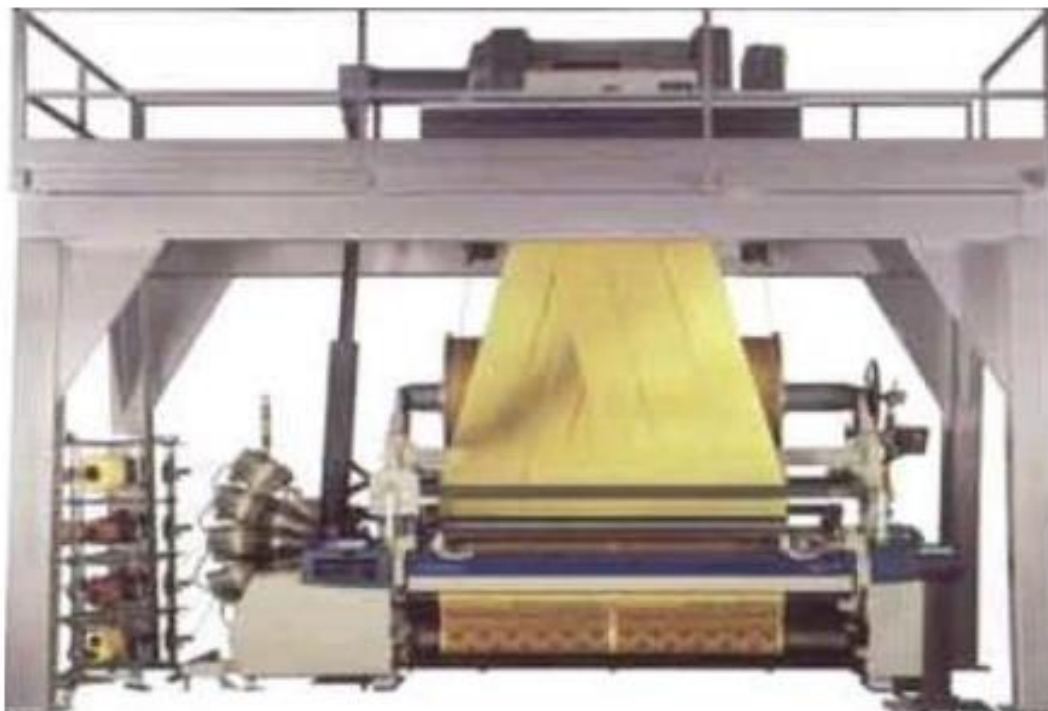
Obrázek 5 Tkací stroj s elektronickým dvoj-zdvižným žakárským zařízením [13]
