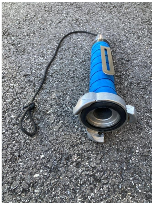
Obrázek 6 Proudnice na 100 m s překážkami
