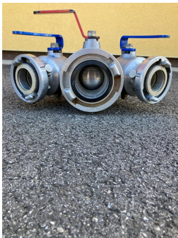
Obrázek 19 Přední strana rozdělovače uprostřed pùlspojka typu DINN B , po stranách pùlspojky typu DINN C Zdroj: vlastní
