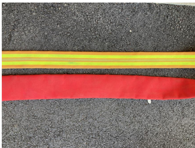
Obrázek 18 Hadice na požární útok nahore hadice typu C. dole hadice typu B
