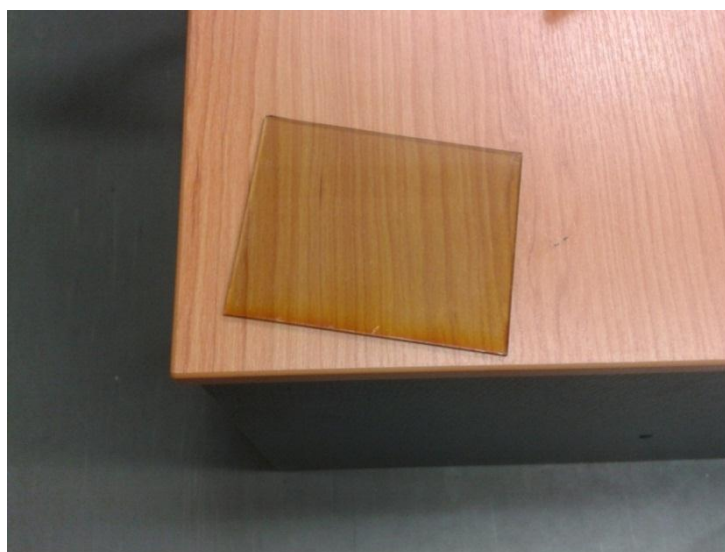
Obr. 24: Výsledná deska při použití GP-2 (expozice 8 min., bělení 8 min.)
