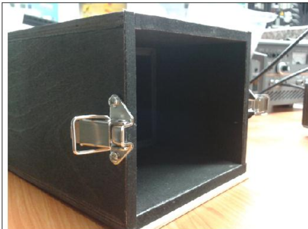
Obr. 19: Zadní strana těla fotoaparátu s řešením uchycení kazety
