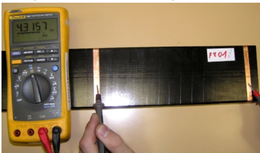
Obr.4: Způsob aplikace proužků měděných pásek na zkušební tyče a způsob měření
