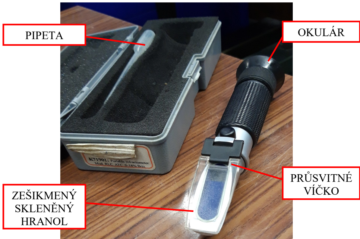
Obr. 06 Ukázka ručního refraktometru RLC ATC 0-18% Brix
