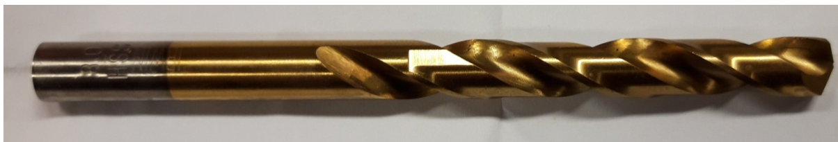
Obr. 04 Ukázka šroubovitého vrtáku ČSN 22 1121 (DIN 338)
