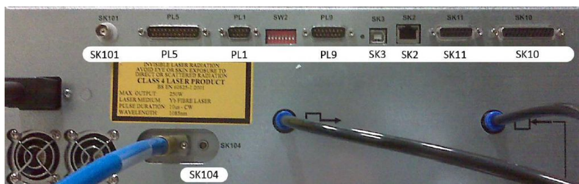
Obr. 27 Přehled konektorů JK 400 FL laseru [31]
