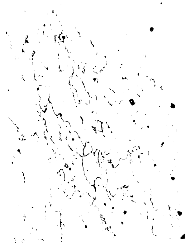
Obr. 55. Vz. č. VII, obl. 4, 770°C, výdrž 25s, vzduch, 500x, nital
