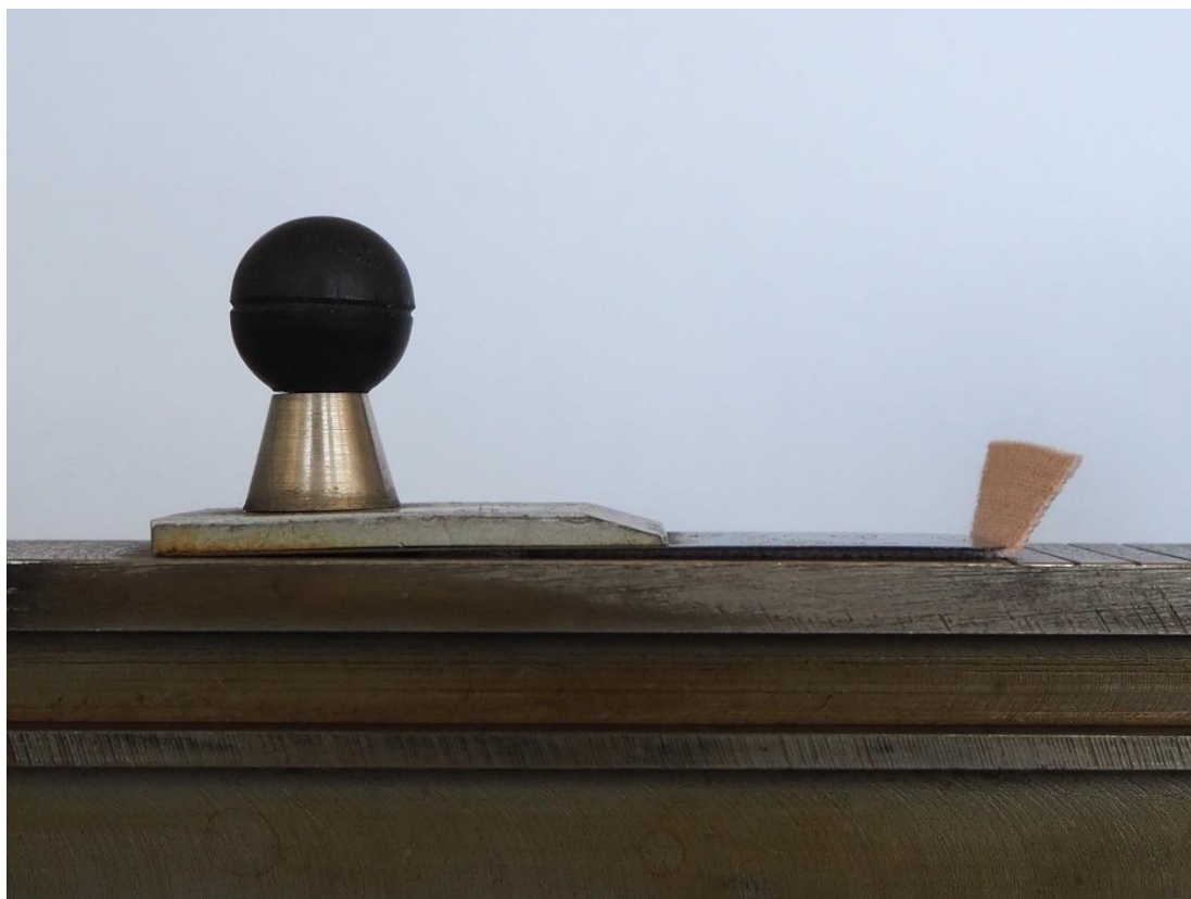
Příloha č. 25 - Vzorky upevněné v přístroji na měření pomocí dutého válce a zatížené závaží.
