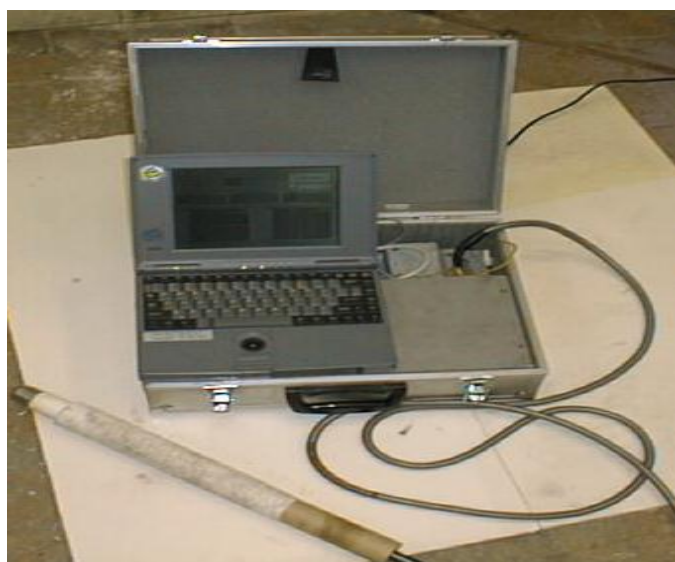
Obr. 2-2 Pohled na měřicí zařízení pro sledování aktivity kyslíku v modifikovaných litinách
