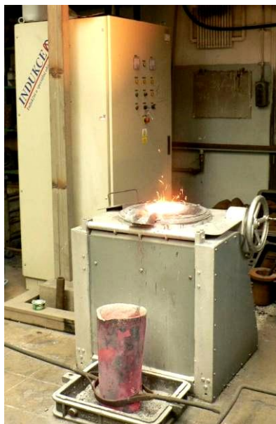
Obr. 3-12 Středofrekvenční indukční pec IO 40 do firmy Indukce s.r.o (pro maximální množství 40 kg taveniny)
