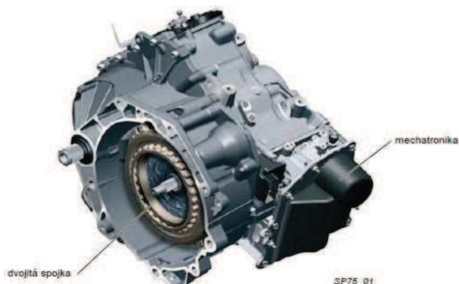
Obrázek 12. – Automatická převodovka DSG7
