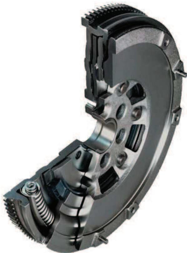
Obrázek 14. – Dvoumotový setrvačnick
