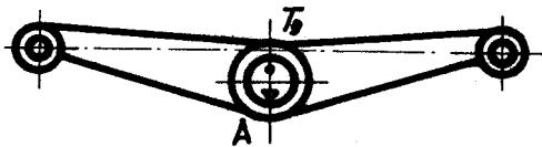
Váha:  $G = 680\text{g}$ Vzdálenost těžiště od osy rotace:  $e = 19,5$ Doba jednoho kyvu:  $t = 0,856 \text{ sec}$
