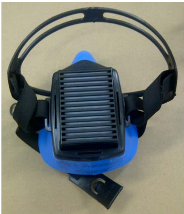
Obr. 5.1 Finální podoba prototypu dýchací polomasky s obdélníkovým filtrem (SILIKON + PA66).
