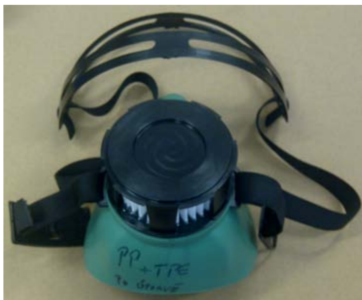
Obr. 5.2 Finální podoba prototypu dýchací polomasky s kruhovým filtrem (TPE + PP).
