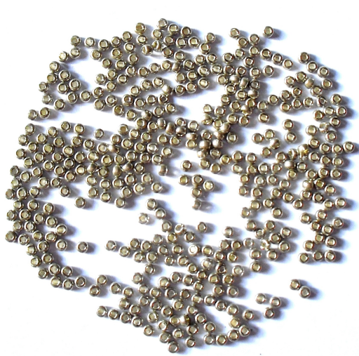
Obr. 22: Vzorek postříbřených perliček, koncentrace c_1
