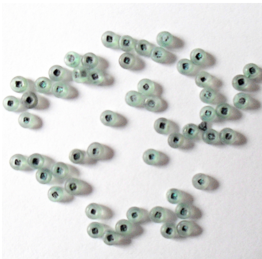
Obr. 31: Vzorek měděné lazury po 1. výpalu
