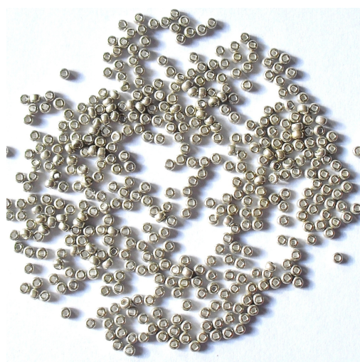
Obr. 24: Vzorek postříbřených perliček, koncentrace c_3
