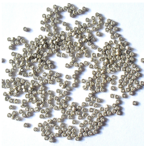
Obr. 42: Vzorek postříbřených perliček, koncentrace c_3
